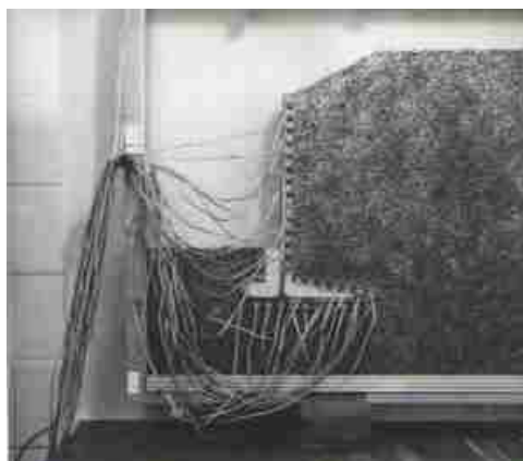
Obr. 1. Kolíčkový model (naľavo) a izostaty ťahových síl vo výstužiach (napravo). Fig. 1. Pin model (left) and tensile isolines in reinforcements (right).
