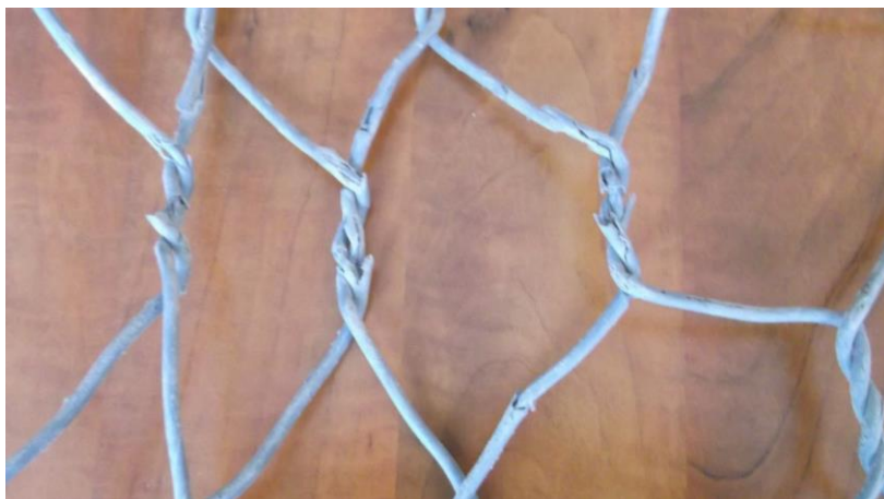
Obr.4 Dvojzákrutová šesťhranná sieť s poškodeným poplastovaním
