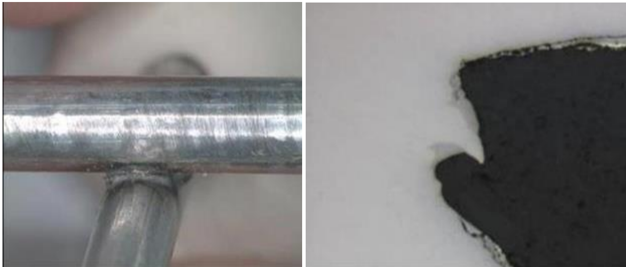
Obr. 15 Príklad kvalitne realizovaného zvaru drôtu s ochranným povlakom ZnAl (naľavo) a výbrus toho istého zvaru (napravo)
