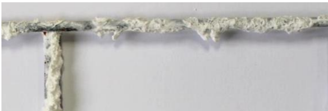
Obr. 9 Príklad bielej korózie na pozinkovanom drôte
